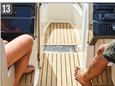
Einzigartiges Ablaufsystem am Bug sorgt dafür, dass sich kein Wasser sammelt und in das Cockpit läuft
