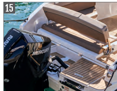
15. Große Badeplattformen und eine Trittstufe bei der Motorbilge ermöglichen einfachen Zugang zu beiden Seiten des Heckspiegels
