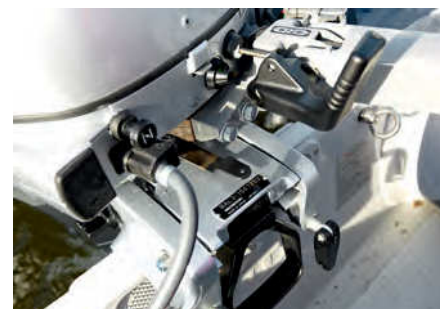
DRAUF UND DRAN Im mobilen Einsatz wird der Motor mit Knebelschrauben (Mitte) befestigt. Tragegriffe (oben) erleichtern den „Landgang“, funktionelle Bedienelemente die Handhabung.
