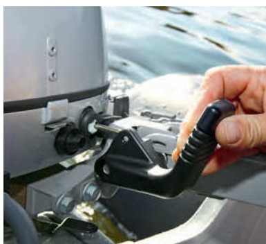
EINER FÜR ALLE Handstartmodelle mit Pinnensteuerung bieten den Vorteil der einfachen und schnellen Montage. Wichtig ist, dass Bedienelemente wie Starter (links), Getriebeschalthebel (mitte), Pinne und Quickstop gut platziert und leichtgängig sind.
