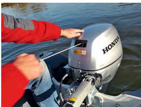
EINER FÜR ALLE Handstartmodelle mit Pinnensteuerung bieten den Vorteil der einfachen und schnellen Montage. Wichtig ist, dass Bedienelemente wie Starter (links), Getriebeschalthebel (mitte), Pinne und Quickstop gut platziert und leichtgängig sind.
