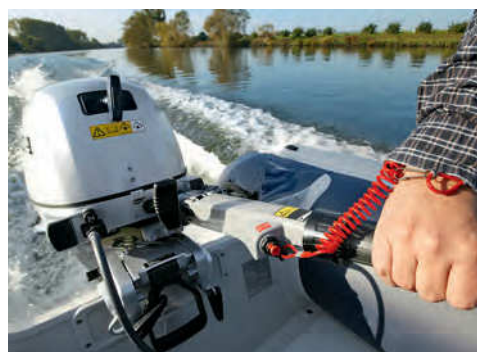
EINER FÜR ALLE Handstartmodelle mit Pinnensteuerung bieten den Vorteil der einfachen und schnellen Montage. Wichtig ist, dass Bedienelemente wie Starter (links), Getriebeschalthebel (mitte), Pinne und Quickstop gut platziert und leichtgängig sind.
