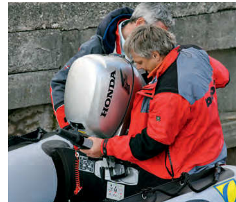
Außenborder ab etwa 10 PS hängt man am besten zu zweit an den Spiegel. Wer dies nicht vom Heck aus erledigen kann, muss ins Boot steigen. Akrobatik vom Steg aus ist zu unsicher.
